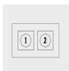
图 1 有粘结预应力梁中一排两束预应力筋时的张拉顺序图
